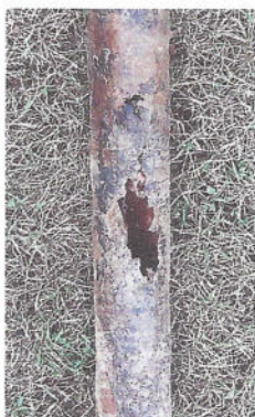
Die ca. 50 Jahre alte Wasserleitung war an vielen Stellen durchgerostet und musste 2020 erneuert werden. Danach wurden die Gartenwege wieder instandgesetzt.
